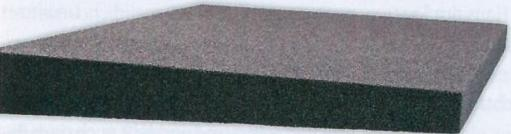
Die Dämmplatten bestehen aus 100% Recyclingglas und werden mit organischen Aktivatoren aufgeschäumt.
