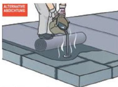
Abdichtungsvariante mit einer Dachdichtungsbahn zeitgleich mit zellfüllenden Deckabstrich. Verbrauch ca. 2 kg/m<sup>2</sup>.
